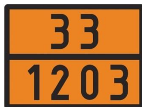
Rys. 1. Tablica ADR do oznaczenia transportu benzyny (węglowodory ciekłe o temperaturze zapłonu poniżej 21°C)
